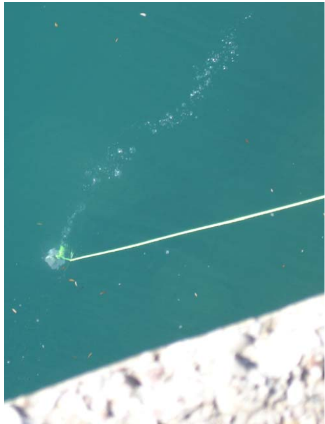
Εικόνα 3.1.2 Δειγματοληψία για διάφορες επί τόπου μετρήσεις και εργαστηριακές αναλύσεις κατάντη της γέφυρας (Θέση 2) στον Ενιπέα Ποταμό με το πλαστικό δοχείο 10 L (αριστερά). Δειγματοληψία για εργαστηριακό προσδιορισμό ΔΟ και ΒΑΟ 5 κατάντη της γέφυρας Άσπρων Σπιτιών (Θέση 6) στον Αλφειό Ποταμό (δεξιά). Διακρίνεται βυθισμένος ο δειγματολήπτης ΒΑΟ 5 ενώ γεμίζει.
