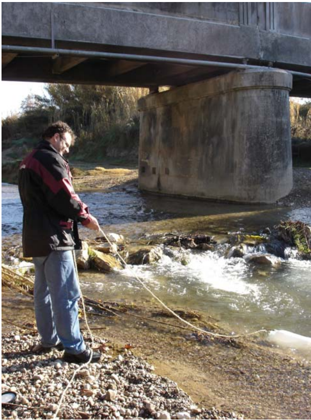
Εικόνα 3.1.2 Δειγματοληψία για διάφορες επί τόπου μετρήσεις και εργαστηριακές αναλύσεις κατάντη της γέφυρας (Θέση 2) στον Ενιπέα Ποταμό με το πλαστικό δοχείο 10 L (αριστερά). Δειγματοληψία για εργαστηριακό προσδιορισμό ΔΟ και ΒΑΟ 5 κατάντη της γέφυρας Άσπρων Σπιτιών (Θέση 6) στον Αλφειό Ποταμό (δεξιά). Διακρίνεται βυθισμένος ο δειγματολήπτης ΒΑΟ 5 ενώ γεμίζει.
