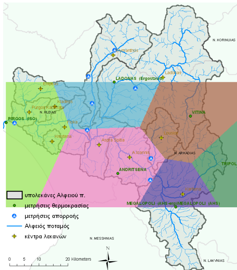
Σχήμα 5.1.15 Προσδιορισμός αντιπροσωπευτικού σταθμού μέτρησης θερμοκρασίας για κάθε υπολεκάνη του Αλφειού με τη μέθοδο της χωρικής κατανομής βάσει της Ευκλείδειας απόστασης (Euclidean distance analysis).
