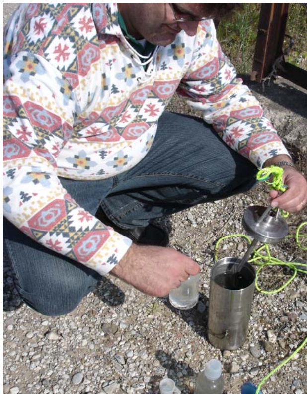
Εικόνα 3.1.3 Δειγματολήπτης για εργαστηριακό προσδιορισμό ΔΟ και ΒΑΟ 5 κατάντη της γέφυρας στον Ενιπέα Ποταμό (Θέση 2) με το πλαστικό δοχείο 10 L (αριστερά) και επί τόπου μετρήσεις ποιοτικών παραμέτρων στην ίδια θέση (δεξιά).
