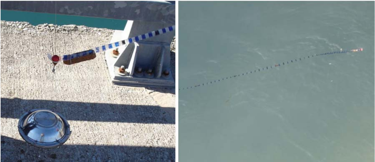
Εικόνα 3.1.7 Βελτιωμένη συσκευή παραγωγής φυσαλλίδων αέρα με την πλαστική μετροταινία μέτρησης του μήκους ανάδυσης των φυσαλλίδων (αριστερά) και βυθισμένη κατάντη της γέφυρας Αγίου Ιωάννη – Σέκκουλα (Θέση 9) κατά την διάρκεια της μέτρησης (δεξιά). Διακρίνεται εμφανώς η πλαστική επιπλέουσα μετροταινία μέτρησης του μήκους ανάδυσης των φυσαλλίδων.
