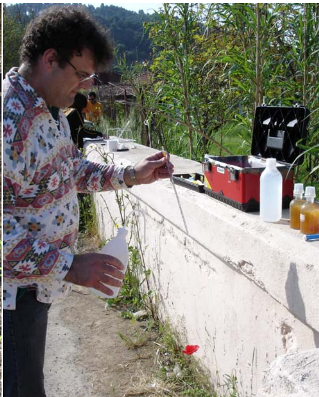
Εικόνα 3.1.3 Δειγματολήπτης για εργαστηριακό προσδιορισμό ΔΟ και ΒΑΟ 5 κατάντη της γέφυρας στον Ενιπέα Ποταμό (Θέση 2) με το πλαστικό δοχείο 10 L (αριστερά) και επί τόπου μετρήσεις ποιοτικών παραμέτρων στην ίδια θέση (δεξιά).
