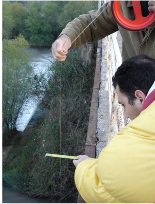
Εικόνα 3.1.5 Μέτρηση απόκλισης νήματος ανηρτημένης σφαίρας, η οποία είναι βυθισμένη κατάντη της γέφυρας Πύργου – Καλαμάτας στον Αλφειό Ποταμό (Θέση 1), από κατακόρυφο νήμα (κίτρινο) άλλης σφαίρας εκτός της ροής. Το λεπτό χαλύβδινο νήμα βρίσκεται στο λευκό σημάδι μόλις άνωθεν του άκρου της μετροταινίας. Η μέτρηση γίνεται σε ακτίνα 0.50 m από το κοινό σημείο ανάρτησης των σφαιρών.
